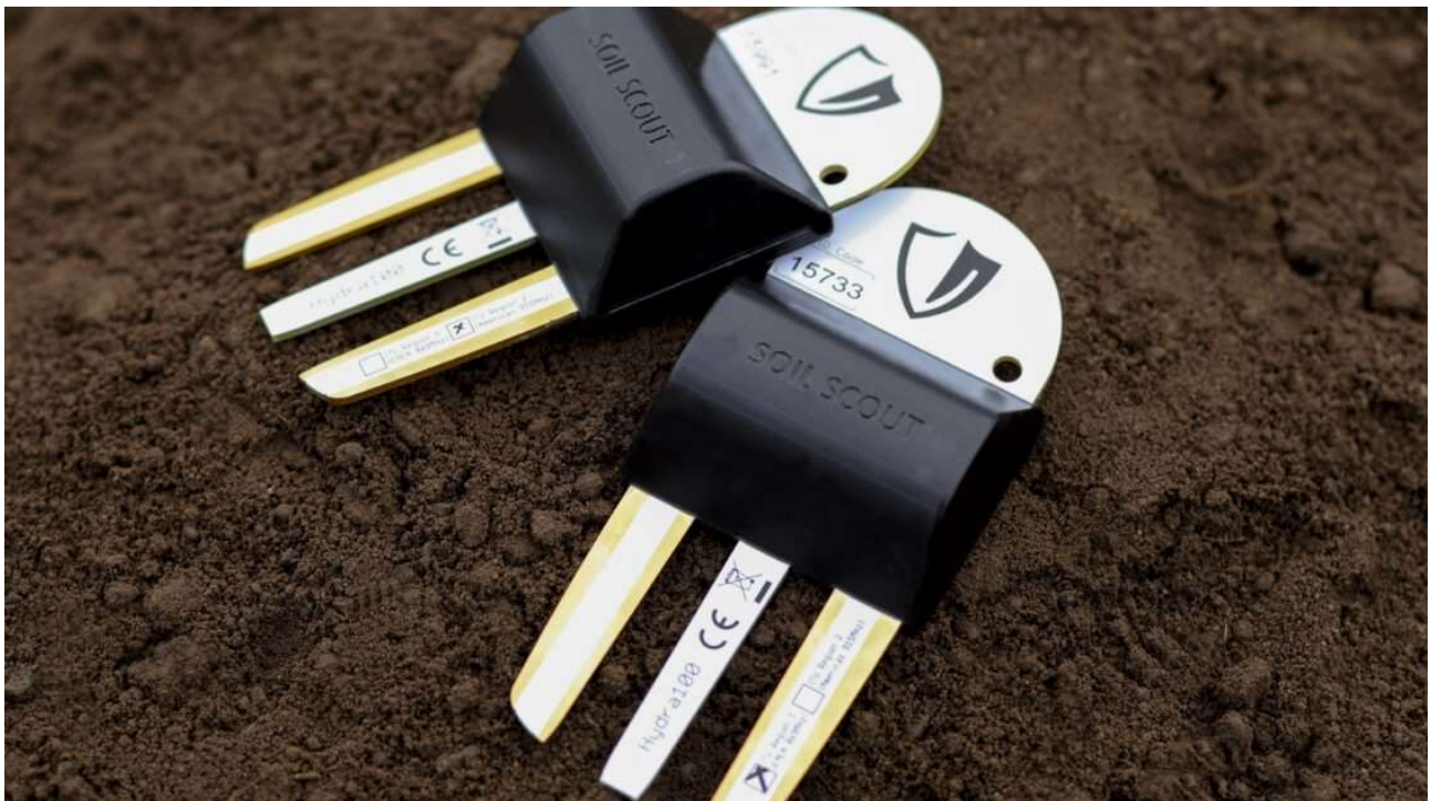
Bild 1: Bild av soil scout sensorer som registrerar bl.a. fuktighet i marken. Johannes Tiusanen ( https://www.agrimedia.fi/soil-scoutin-johannes-tiusanen-palkittiin-agri-inno-palkinnolla/ )
