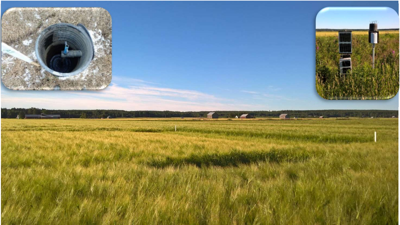
Bild 3: Försöksfälten på Söderfjärden består av tre åkerskiften med olika dräneringssystem. På den stora bilden syns markerade provrutor. På den lilla infällda bilden till vänster, syns insidan av en dräneringsbrunn och till höger en automatisk mätstation. Foto: Anna Bonde.
